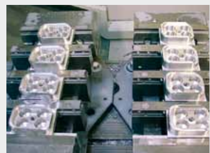
Dans la 2ème opération de serrage, le bord de serrage est enlevé au moyen d'une fraise.
