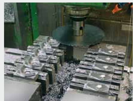
Une fois l'usinage terminé, la « tête perdue » est séparée de la pièce à l'aide d'une fraise à disque.
