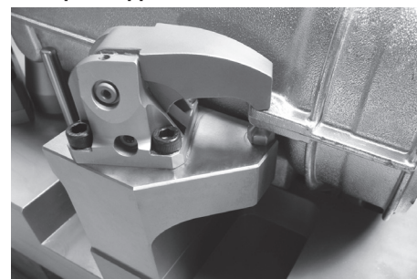
Serrage d'une pièce en fonte
