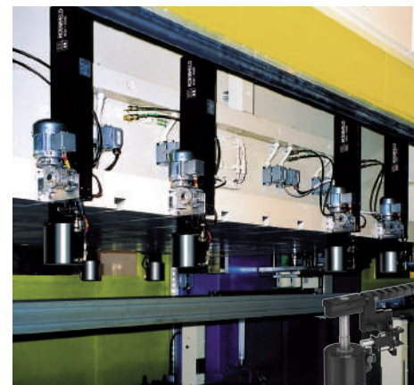
6 Sistema de sujeción rápida de troqueles con cadena de empujador en el ram de la prensa de una prensa de doble columna. Elemento de sujeción. Cilindro de pistón hueco.
